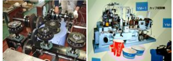
装置の心臓部といわれるカムとギヤによる駆動部
