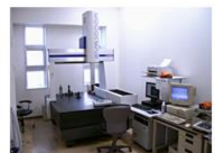
高精度 CNC 三次元座標測定器 測定範囲 800 mm × 1000 mm (3 台)
