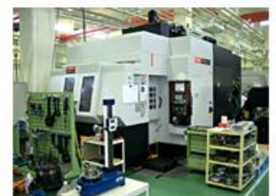
5 軸マシニング (1 台) 2 パレット 加工範囲 730 mm × 730 mm
