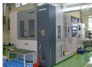
横型マシニング (9 台) 2 パレット 加工範囲 630 mm × 630 mm
