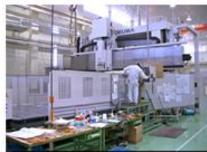
門型マシニング (2 台) 傾斜アタッチメント付 5 面 加工範囲 2500 mm × 4800 mm
