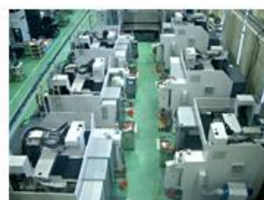
縦型マシニング (36 台) 加工範囲 580 mm × 1050 mm
