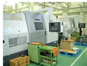
大型 NC 旋盤 (5 台) 加工範囲 \phi 800
